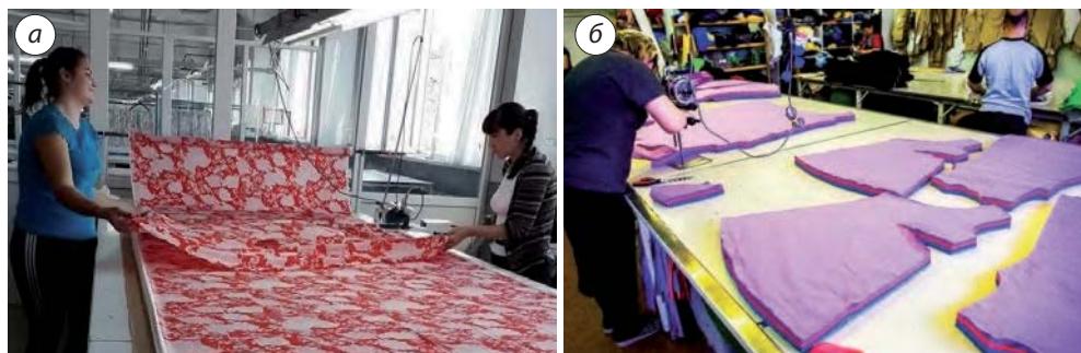
Рис. 86. Рабочие раскройного цеха: а — настильщик; б — раскройщик
