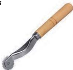
Рис. 69. Резец (а), перевод выкройки с помощью резца (б)
