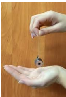
Рис. 89. Проверка натяжения нижней нитки
