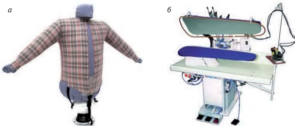
Рис. 108. Паровоздушный манекен (а), пресс (б)
