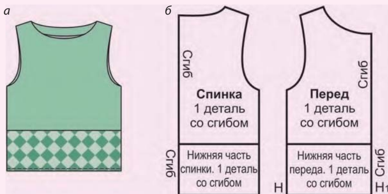
Рис. 76. Моделирование изделия, изготовленного из двух видов ткани, соединённых по вертикали: а — эскиз; б — моделирование изделия
