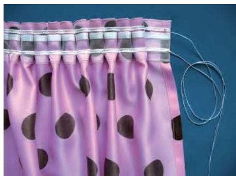
Рис. 101. Обработка верхнего среза шторной лентой
