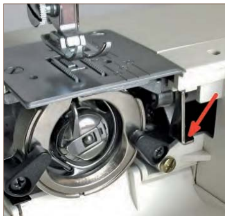
Рис. 90. Регулятор высоты подъёма зубчатой рейки двигателя ткани
