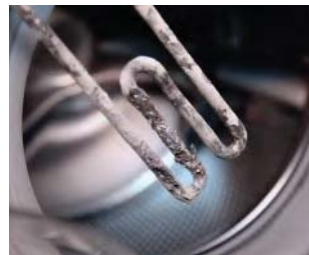
Рис. 112. Накипь на обогревательном элементе стиральной машины
