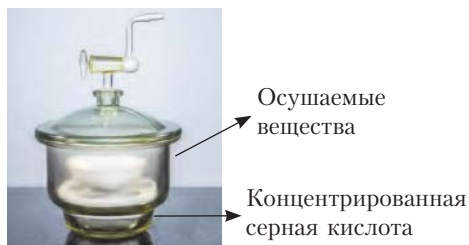
Рис. 86. Эксикатор для хранения и сушки гигроскопичных веществ
