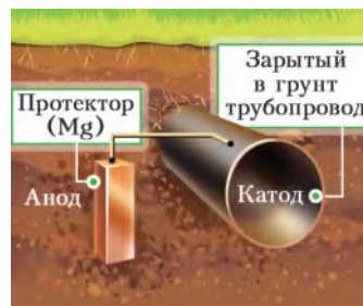
Рис. 116. Защита от коррозии подземного стального трубопровода
