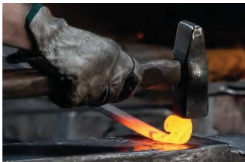
Рис. 104. Ковка металла как демонстрация его пластичности
