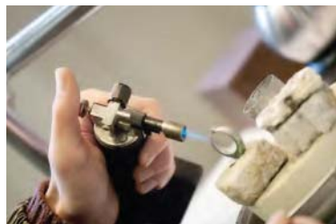
Рис. 66. Сварка ювелирных изделий кислородно-водородным пламенем
