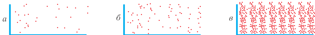
Рис. 181. Результаты компьютерного моделирования явления дифракции N электронов на двух щелях: a — N = 27 ; б — N = 70 ; в — N = 735
