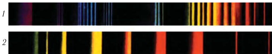
Рис. 200. Полосатые спектры испускания угольной дуги (1) и молекул йода (2)
