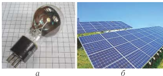
Рис. 177. Фотоэлемент: а — вакуумный (газонаполненный); б — полупроводниковый
