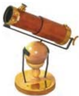
Рис. 121. Телескоп-рефлектор Ньютона и ход лучей в нем
