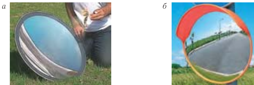
Рис. 112. Сферические зеркала: a — вогнутое; б — выпуклое
