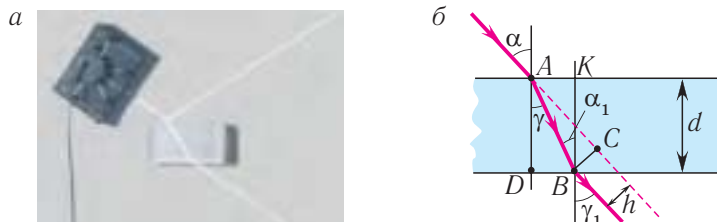
Рис. 138. а — световой луч, проходящий через плоскопараллельную пластинку; б — ход луча в пластинке
