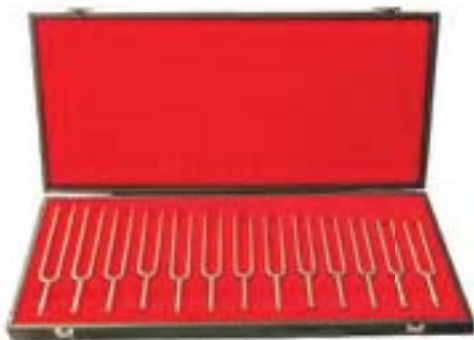
Рис. 46. Камертоны с частотами колебаний звуков первой октавы
